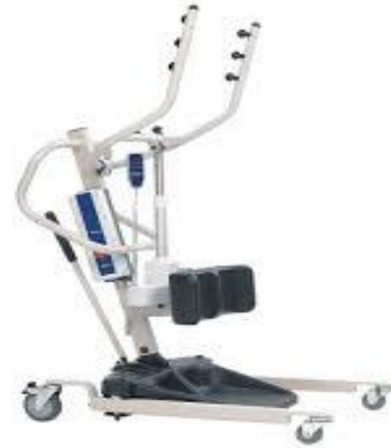
Grúa de dimensiones reducidas para lugares estrechos y difíciles para moverse.. Está dotada de pistón, caja de control, baterías y paro de emergencia.
